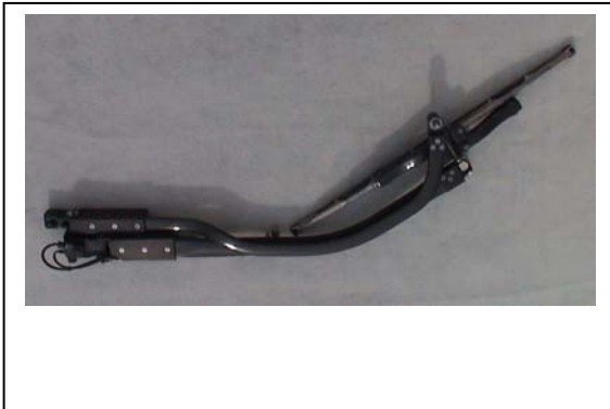
CFK-Scheibenwischerarme für ICE-3 High speed train windscreen wipers (CFRP)
