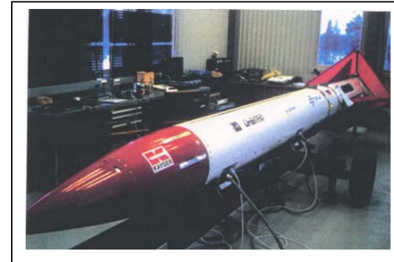
MIKROBA \mu g - Flugkörper Mikrogravity drop container [Mach2.2]
