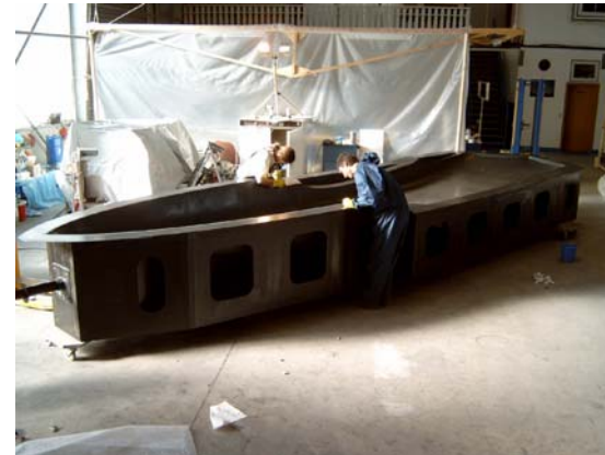
Herstellung Laminierwerkzeug Rumpf Fuselage mold
