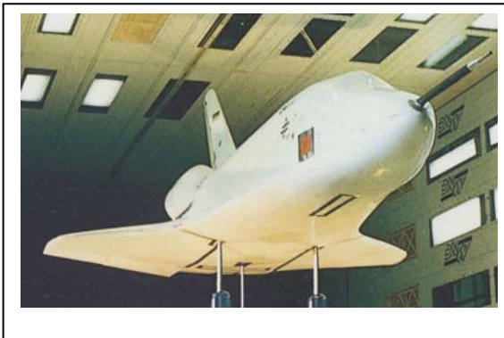
FALKE Freiflugmodell (1:6) STS-1 Free flight model STS-1 [Mach 1.4]
