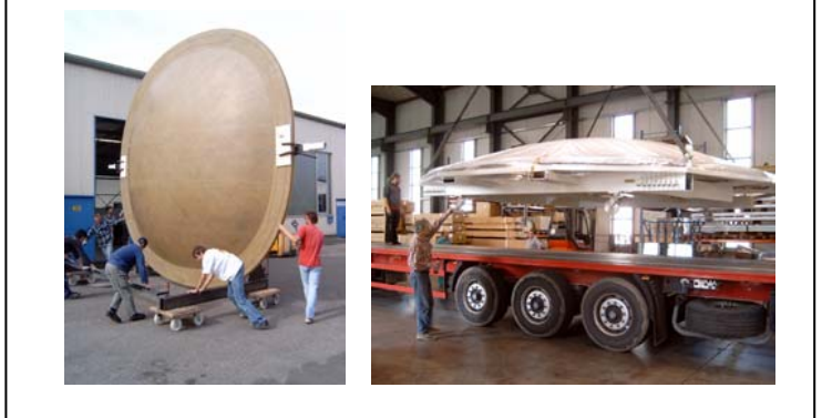
Laminierwerkzeug für Druckkalotte B787 Mold, Rear pressur bulkhead B787
