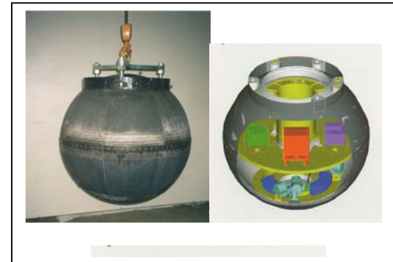
MIRKA Struktur/TPS Wiedereintrittskörper Reentry capsule structure + Avcoat TPS
