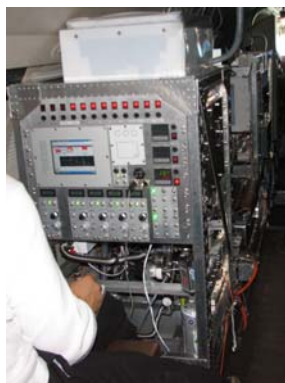
Abb. 4: Realisierung der PeRCA-Meßtechnik für den Flugzeugeinsatz: Der DUALER in der DLR-Falcon innerhalb der internationalen AMMA-Messkampagne im Juli und August 2006 (Afrikanischer Monsun: Multidisziplinäre Analysen).
