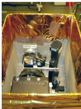
Abb. 3: Testaufbau für das abbildende Spektrometer für einen möglichen Einsatz auf HALO. Im Vordergrund die CCD-Kamera, in der Mitte das Gitter und rechts der Lichtleiter über den ein definierter Lichtinput eingekoppelt wird.
